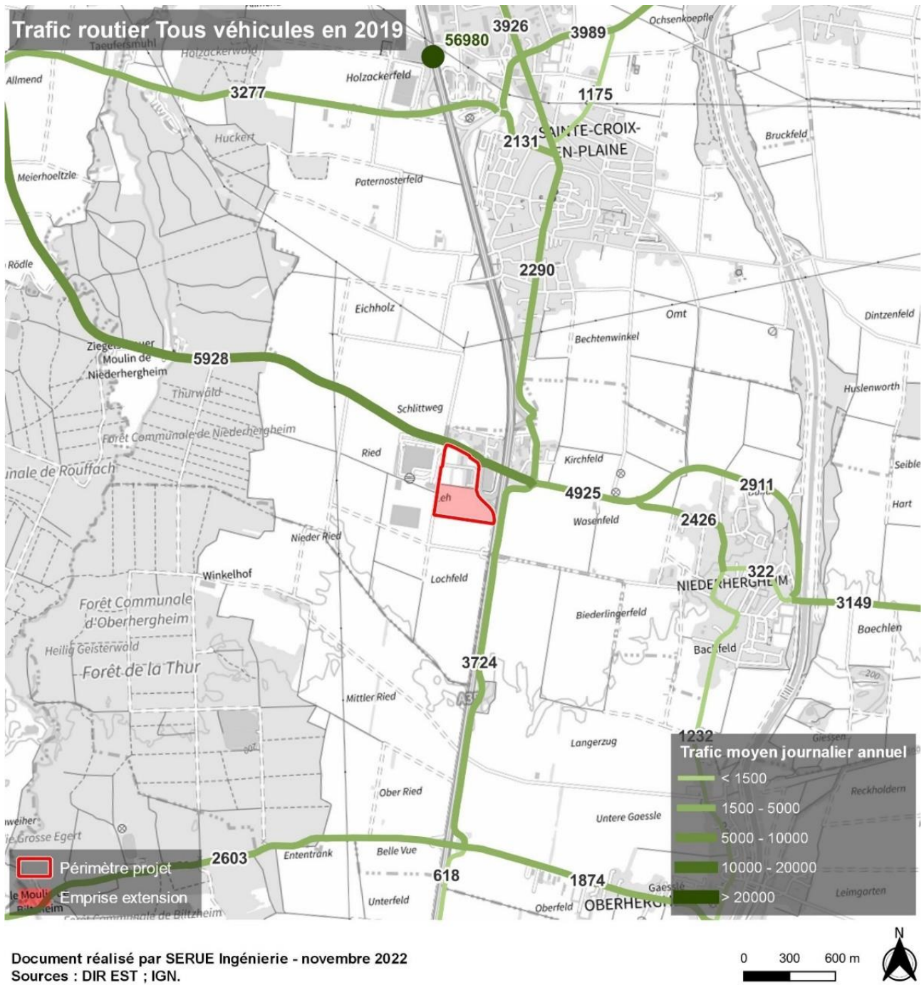
Figure 25 : Cartographie illustrant le trafic routier tous véhicules en 2019 dans le secteur du projet
